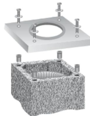
**18. Изоляционные плиты, устанавливаемые в верхнем блоке дымохода, необходимо обрезать так, чтобы изоляция заканчивалась на расстоянии 6 - 8 см от верхней грани блока!!!**
