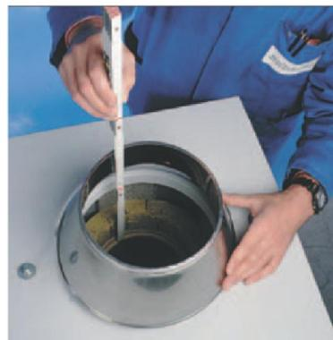
**22. Используйте его как средство измерения для определения высоты верхнего керамического элемента.**
